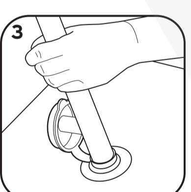
Verschlusskappe entfernen. Staubsaugerohr aufsetzen und Luft aus dem Beutel saugen. Drücken des Beutels erleichtert das Absaugen.
